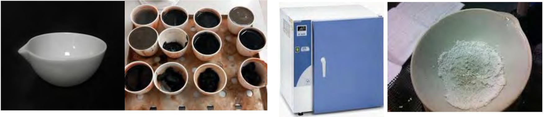
$$\text{Sólidos totales} \left( \frac{\text{mg}}{\text{l}} \right) = \frac{(\text{Peso capsula con residuo seco} - \text{Peso capsula limpia}) * 1000}{\text{volumen}}$$
