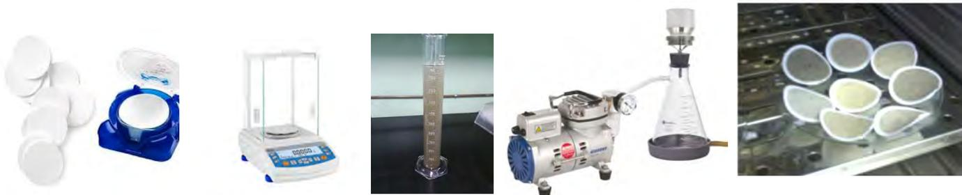
$$\text{Sólidos en suspensión } \left( \frac{\text{mg}}{\text{l}} \right) = \frac{(\text{Filtro con residuo seco} - \text{Filtro limpio}) * 1000}{\text{volumen}}$$
