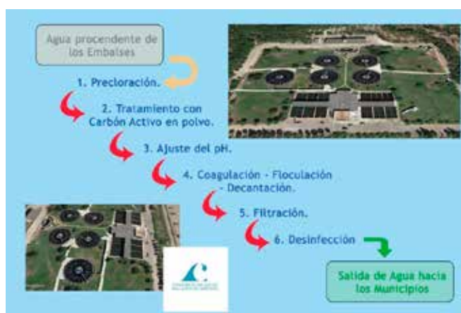
Figura 30. Tratamientos de la ETAP El Montañés. Fuente: Plan de Gestión del Riesgo pro Sequía de Cádiz.
