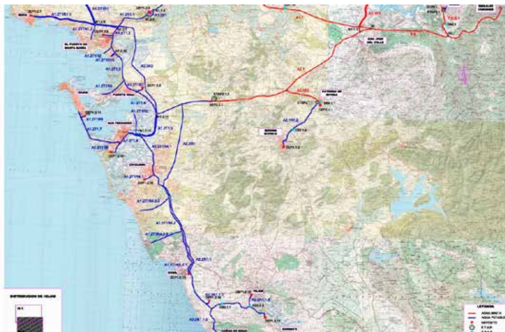
Figura 31. Situación de las arterias principales del Consorcio de Aguas de la Zona Gaditana que surten al municipio de Chiclana de la Frontera. Fuente: Borrador del Plan de Emergencias por Sequía del Consorcio de Aguas de la Zona Gaditana.
