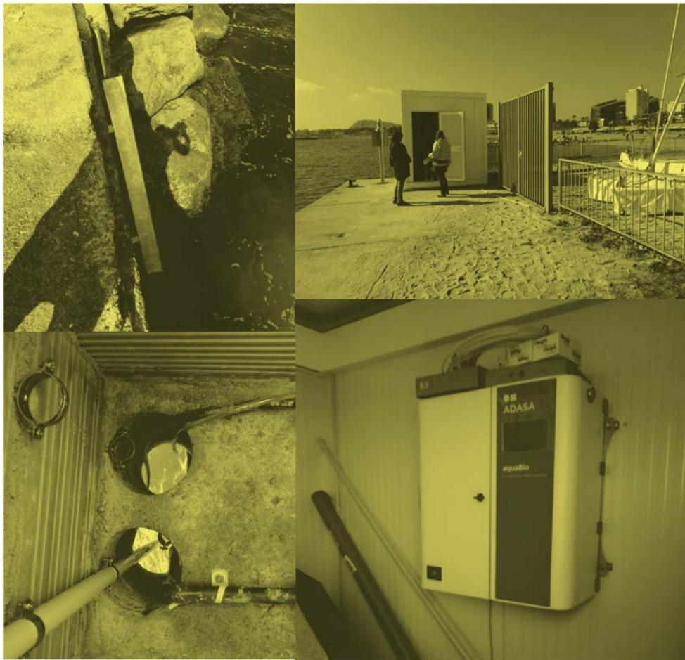
Los equipos instalados, denominados “AquaBio”, son equipos de medida continua de E.coli y enterococos en agua superficial. El principio de medida para los E.coli es la fluorimetría y la colorimetría para los enterococos. El rango es de 0 – 108NMP y el tiempo de detección entre 3 h a 10,5 h.
